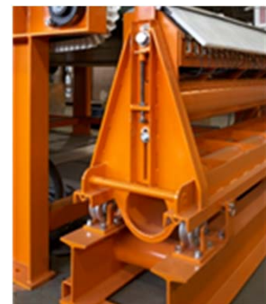
エリーズの電動パドルスタンドは、上下、前後、角度付上下動の6方向の動きをします。
